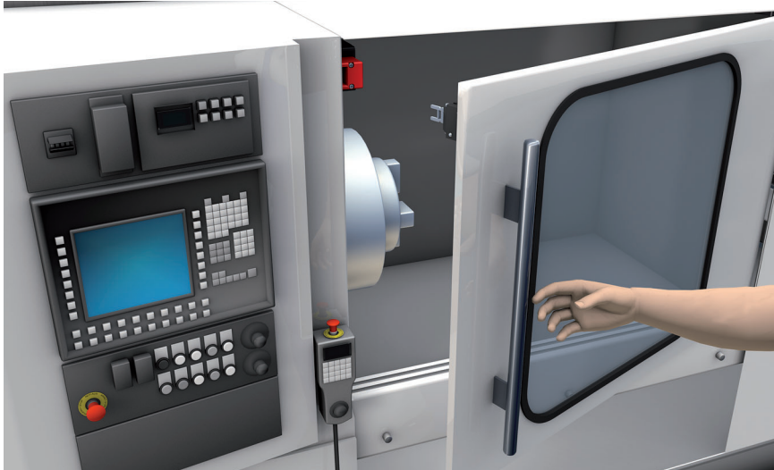
Interverrouillage de sécurité dans un centre d'usinage des métaux avec temps de mise à l'arrêt
