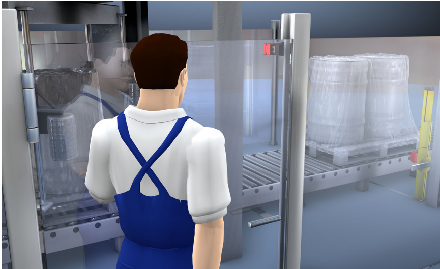
Interrupteur de sécurité S200 sur la porte de la station d'une enrouleuse de feuilles
